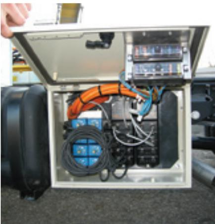
*Der Joystick steuert die Anbaugeräte nicht direkt, sondern über ein kompaktes, wasserdichtes Steuergerät, welches die elektrischen Befehle an die Hydraulik weiterleitet. Auf unserem Bild ein Iveco Daily.*
