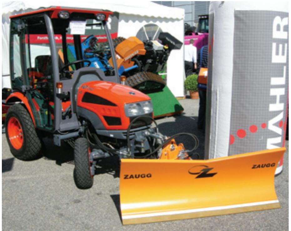
*Kompakttraktor der leichten Klasse mit Allradantrieb. Zur simplen Schneeräumung von Garage-Vorplätzen und schmalen Wegen geeignet. Für Trottoirräumung jedoch völlig untauglich weil die kleinen Vorderräder das Erklimmen von hohen Randsteinkanten nicht bewältigen. Hierzu kommen nur Kompakttraktoren mit Allradantrieb und entsprechend grösseren Vorderrädern in Frage.*
