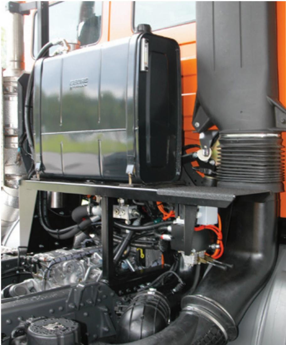
*Je nach Anzahl und Grösse der Anbaugeräte benötigt es eine entsprechende Menge an Hydrauliköl, beziehungsweise einen zusätzlichen Tank. Bei diesem MAN-Lastwagen fand sich Platz dazu hinter der Fahrerkabine.*
