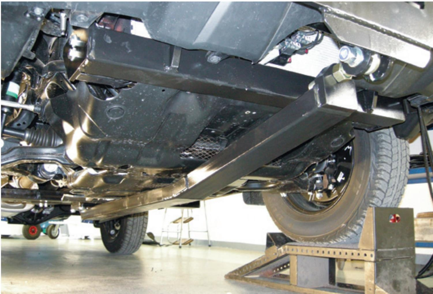
*Aufwendige Verstärkungen im Unterbau eines Toyota LandCruisers. Solide Vierkant-Stahlelemente reichen sogar bis hinter die Hinterachse, um extreme Scherkräfte ohne Schaden für das Chassis verkraften zu können.*
