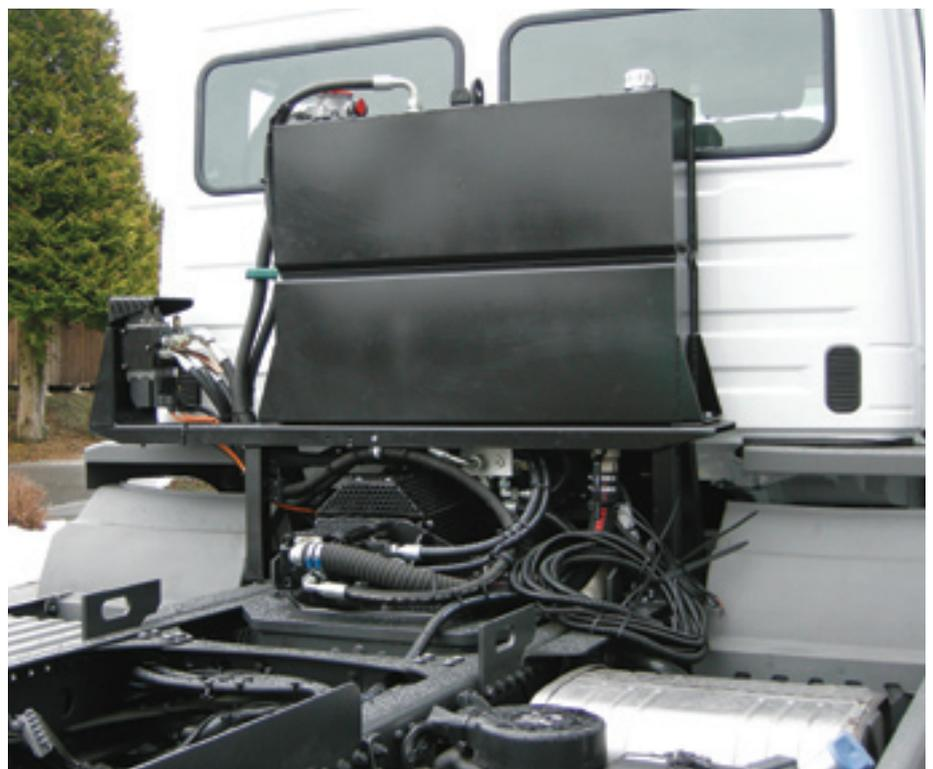
*Auch bei diesem Mercedes-Benz ATEGO konnte der Hydrauliköltank hinter der Fahrerkabine montiert werden.*
