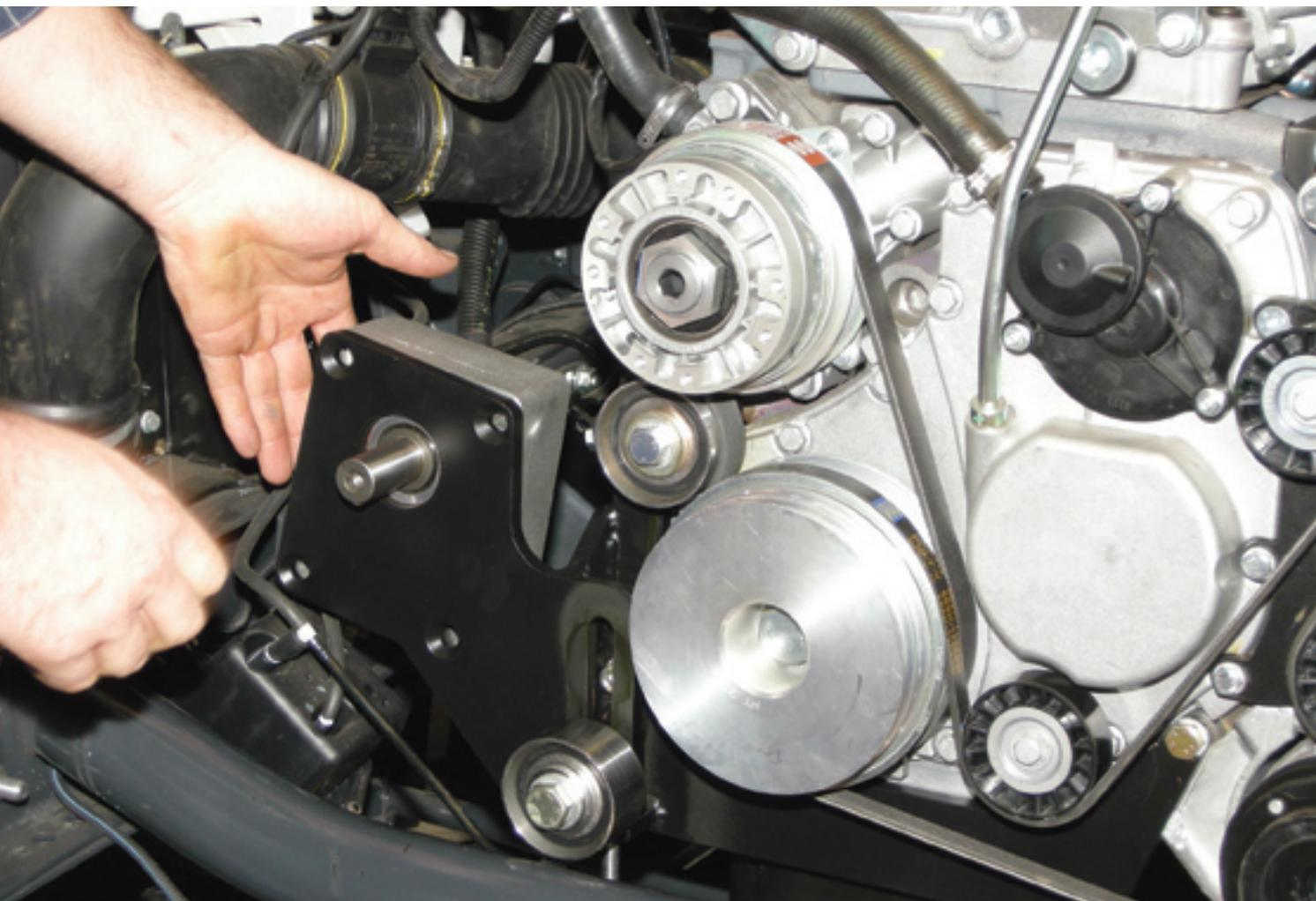
*Einbau der per Keilrippenriemen (Poly-V-Flachriemen) mechanisch angetriebenen Hydraulikpumpe an einem Iveco Daily. Viel Patz ist nicht, aber die ZAUGG-Mechaniker schafften das Kunststück trotzdem. Das grösste Problem ist das genaue «Fluchten» des Boulies (Antriebsrad), sonst zerfetzt es in Rekordzeit den Flachriemen.*
