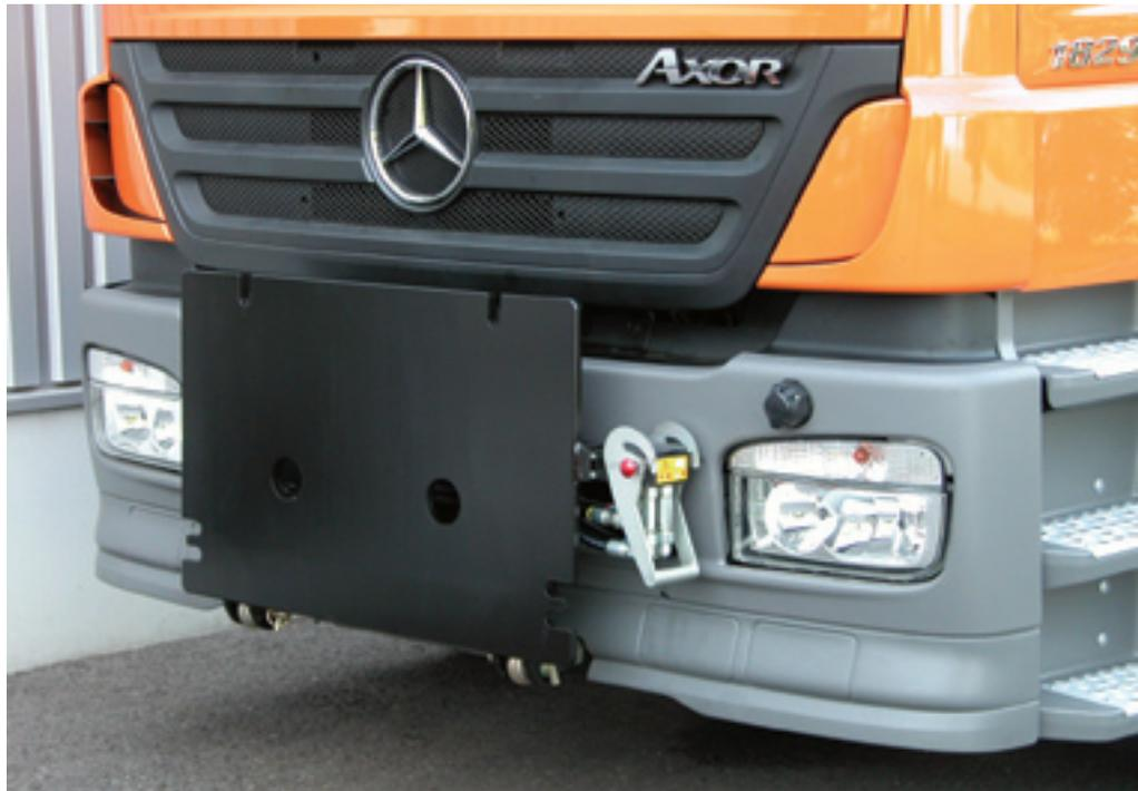
*Genormte Schnellmontageplatte an einem Mercedes-Lastwagen im Normaleinsatz. Alle Hydraulikkupplungen sind bestmöglich hinter der Platte versteckt und mit einem einzigen Patentverschluss abgedichtet und geschützt. Die Räumdienste schätzen solche Vorrichtungen, denn bei plötzlichem Schneefall herrscht grosse Eile bei der Montage der Schneepflüge. Undichte oder beschädigte Anschlüsse sind gar nicht willkommen.*
