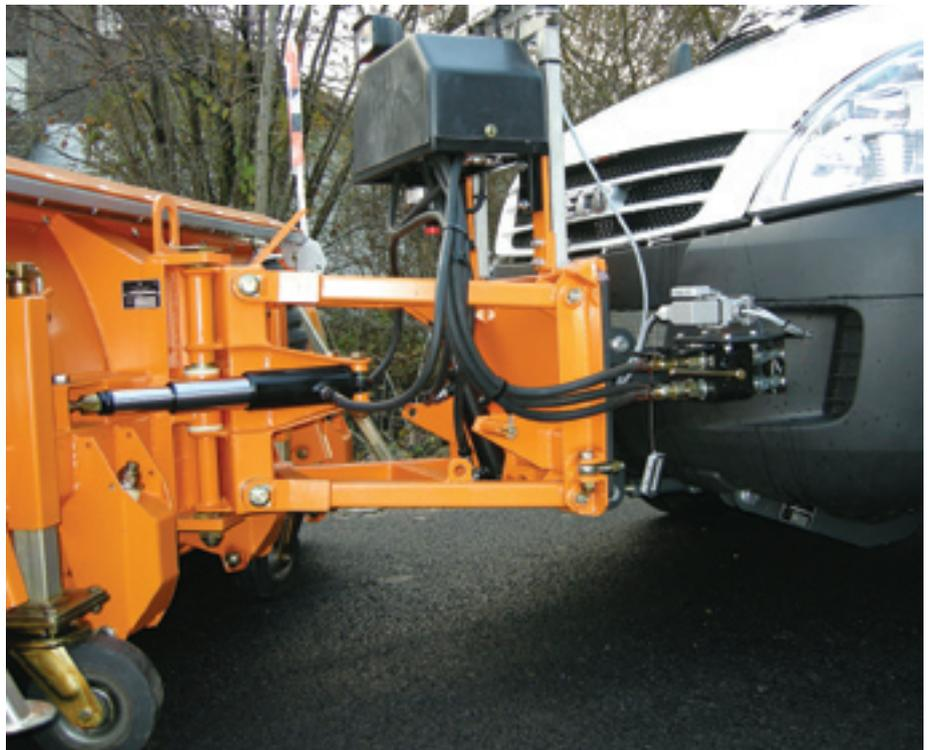
Das Elektropumpen Aggregat ist auf dem Schneepflug aufgebaut und durch eine Kunststoffhaube zuverlässig gegen Spritzwasser und Salzsole geschützt. Auch für kleinere Fahrzeuge bietet ZAUGG eine hydraulische Schneepfluggentlastung für boden- und fahrzeugschonenden Einsatz.
