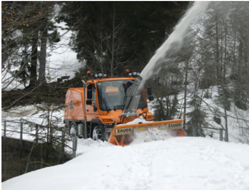
Revival bei ZAUGG: Eine UNIMOG-Schneefräse mit normalem Fahrmotor und separatem, bärenstarken Antriebsmotor im rückwärtigen Aufbau für die Fräse.
