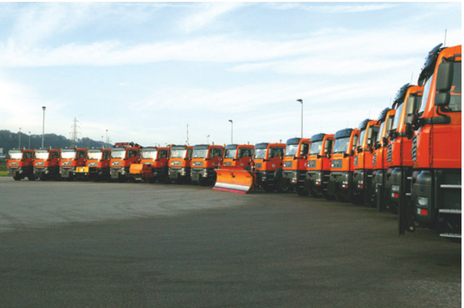
MAN-Strassenunterhaltsflotte im Autobahnwerkhof von Yverdon. Sämtliche Lastwagen sind mit Anbauplatten für Schneepflüge bestückt. Meist zusätzlich mit Anschlüssen für Heck-Salzstreugeräte versehen. Allzeit bereit für den Winterdienst.
