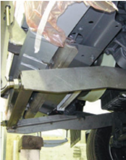
Hängende Schneepflug-Anbauplatte mit verstellbarer Abstützung auf dem Fahrzeugchassis.
