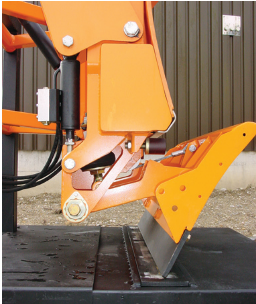
Das sogenannte ZAUGG-Elementabfederungs-System schützt den Schneepflug und das Fahrzeug beim Überfahren von Hindernissen. Bemerkenswert die geringe Masse: Nur 1/3 des Schneepfluges muss dem Hindernis ausweichen. Funktioniert auch bei einer Räumgeschwindigkeit von bis zu 60 km/h. Je nach Modell können Hindernisse von 150 mm Höhe überfahren werden.
