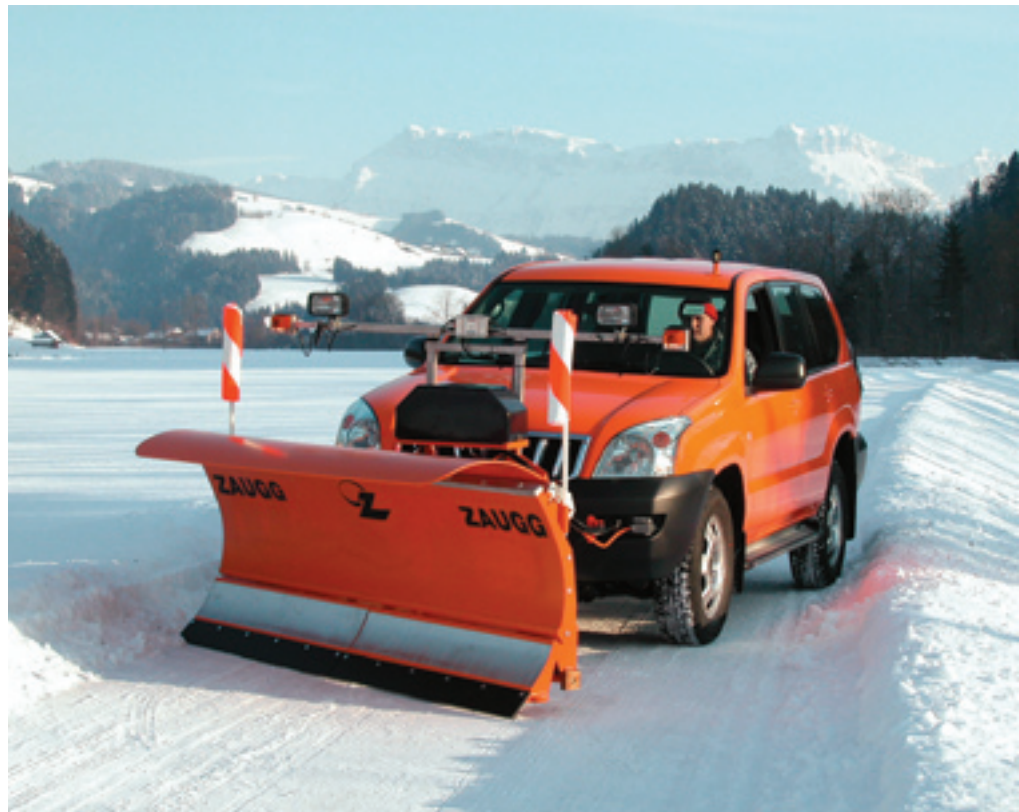
Im Flachland und in den Voralpenregionen kommt heute dieses Anbau-System von ZAUGG zur Anwendung. Der «Pflug», beziehungsweise das Räumschild besteht aus verschiedenen Materialien. Einerseits soll unnützes Gewicht reduziert, die Abnutzung minimiert und das Festkleben von Schnee vermieden werden. Das Räumschild kann elektrisch per Joystick vom Fahrer ferngesteuert werden.
